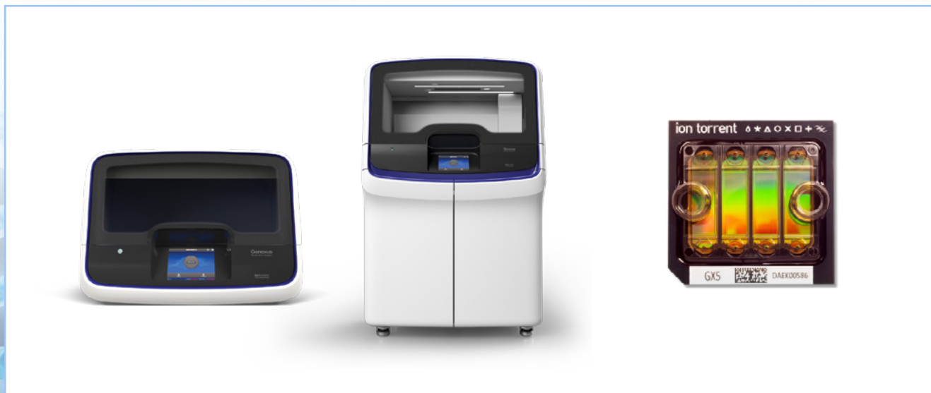
Fig 1. Ion Torrent Genexus Purification System(좌)은 핵산 추출, 정제 및 정량을 자동화한다. 혈장 샘플 또는 FFPE 샘플의 용해물 등을 NGS 시스템에 곧바로 넣을 수 있는 샘플로 적합하게 준비시켜 준다. 제넥서스 (Ion Torrent Genexus Integrated Sequencer)(중)는 4개의 lane으로 나뉘어진 Ion GX5 chip(우)을 사용하여, 최대 4번의 run을 2주에 걸쳐 나누어 할 수 있는 경제적인 NGS 운용으로 1일 이내 NGS 결과 도출이 가능하다.
